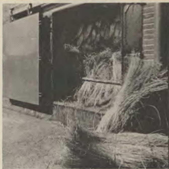
3 Fünf bis acht Tage dauert die Wasserröste des Flachses. Dabei werden in Bassins mit 28 bis 32 Grad warmem Wasser die Kittsubstanzen im Flachsstengel zersetzt, so daß sich die Bastfasern später besser auslösen lassen.
